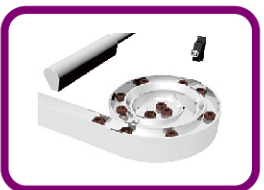
震動送料機上物件的靜 電消除與微塵處理
